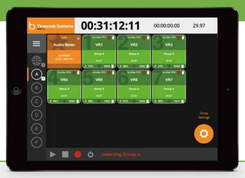
このシンプルなダッシュボード型アプリを使用することで、 スマートフォン、タブレット端末またはPCから、 複数の Timecode Systems 製デバイスや互換性の あるカメラおよび音声収録機にアクセスし、それらの 機器を遠隔操作により表示、監視、および制御できます。
