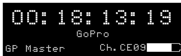
上の例のCh.CE09は、SyncBac PROがRFチャンネル09を使う設定になっていることを示します。
