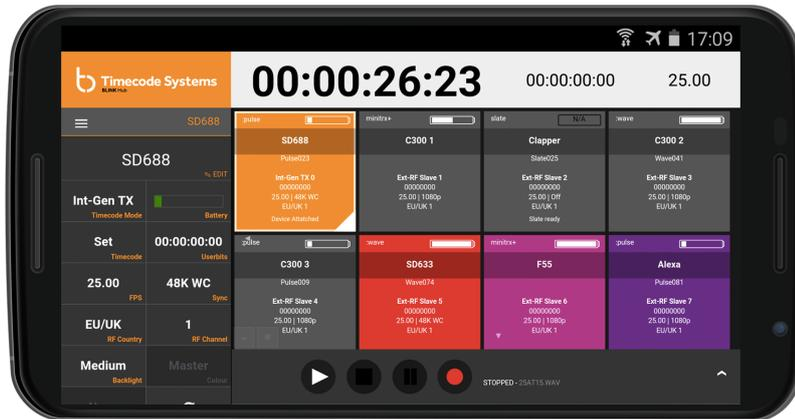
BLINK Hubでは、BLINKネットワーク上の機器ごとにステータスパネルが用意されています。このステータスパネルには、機器とその付属装置に関する様々なステータス情報が表示されます。よって、SyncBac PROと、それに接続されているHERO4™のステータスを表示できます。
