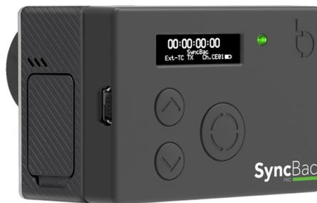
SyncBac PROは、高精度のタイムコードジェネレーター機能とマルチチャンネル対応デジタルタイムコードトランシーバー機能を備えています。次のような使い方が可能です。
