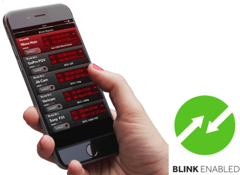
各B:LINKスレーブ機は、自身のステータスと設定をB:LINKマスター機に送信し続けています。B:LINKマスター機は、MovieSlate 8やTimecode Buddy: appなどのアプリを使うことで、こうした情報のすべてを表示できるだけでなく、一部の機能をリモート制御することもできます。
