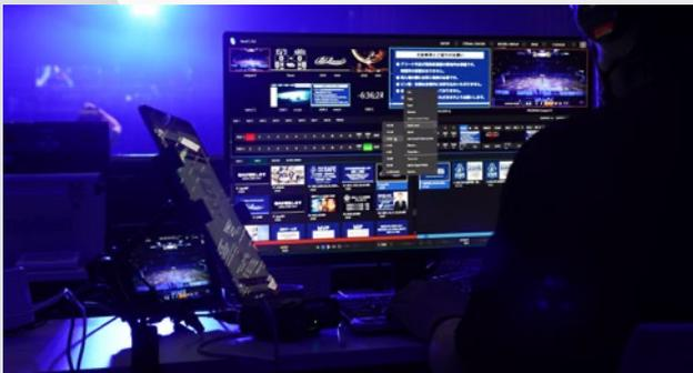
テクノネットは、映像制作の基本となるスイッチング・収録・配信・合成・テロップ作成の機能を1台に搭載した、オールインワンの映像制作システムNewTek TriCaster 2 Eliteを中心に今回のシステムを組んでいる。
